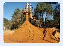
Sous l'action de la force centripète, le sable concentré sur le centre du cyclone tombe, presque sec. L'ocre et l'eau s'écoulent vers des bassins de décantation de 200 m³ environ.
